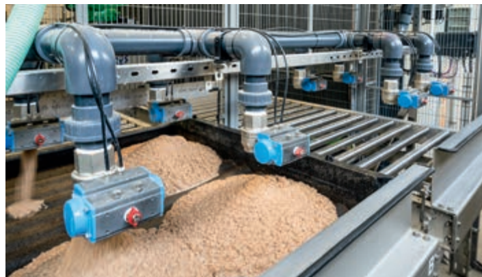
Über vier Futterventile/Kiste wird das frische Futter für die einwöchige Mast ausdosiert
